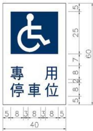
(註) 白底、藍字、鋁板、圖示為藍底白色圖案(貼高級反光材料紙)
