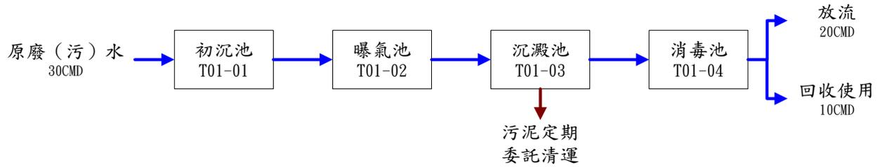
圖 1、現行廢（污）水處理流程流向示意圖
