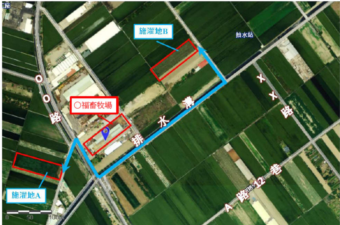
圖3 沼液沼渣由○福畜牧場管線輸送(或槽車載運)至施灌地的輸(運)送路線圖
